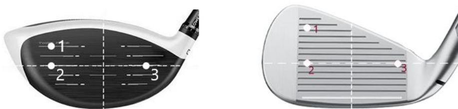
图 18 木杆和铁杆标记点粘贴（左木杆，右铁杆）
